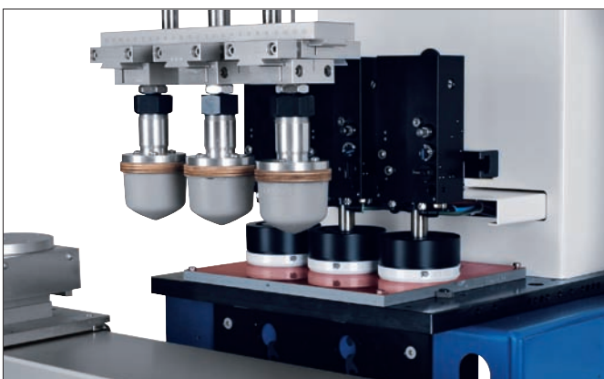
TPE 250 auf Maschinensockel MS 250 mit Verschiebetisch VTP, Koordinatentisch KT 30 und Winkeltisch rastend TPE 250 on machine base MS 250 with sliding table VTP, coordinate table KT 30 and angular table
