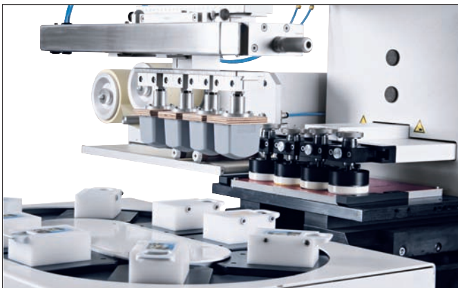
TPE 250 auf Maschinensockel MS 250 mit Verschiebetisch VTP, Koordinatentisch KT 30 und Winkeltisch rastend TPE 250 on machine base MS 250 with sliding table VTP, coordinate table KT 30 and angular table
