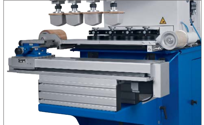
Transfert Carré TFC- S 114 und Flammgerät FLG 201 an TPE 400 Transfert Carré TFC- S 114 and flame unit FLG 201 on TPE 400
