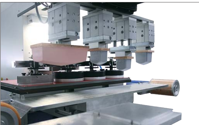
TPX 550 mit Verschiebetisch und Sicherheitsverschalung mit Lichtschranke TPX 550 with shuttle table and safety guarding with light curtain
